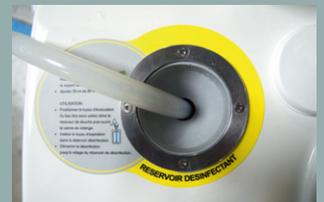
Ouvrez la vanne de vidange du bac des eaux usées. Remplissez le réservoir désinfectant avec de l'eau et du désinfectant BFR 4.0. Démarrez la désinfection automatique du circuit d'aspiration des eaux sales jusqu'à ce que le réservoir de désinfectant soit vide.
