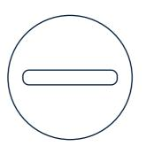
Fente boîte aux lettes d'une longueur de 220mm et d'une hauteur de 25mm.
