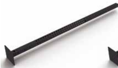
55073800 Poste 9 ft upright. 2,75 m. Medidas: Poste: 7,5. Agujero: 275 mm. Distancia agujero: 5 cm. Grosor: 3,3mm. Peso: 19 kg.
