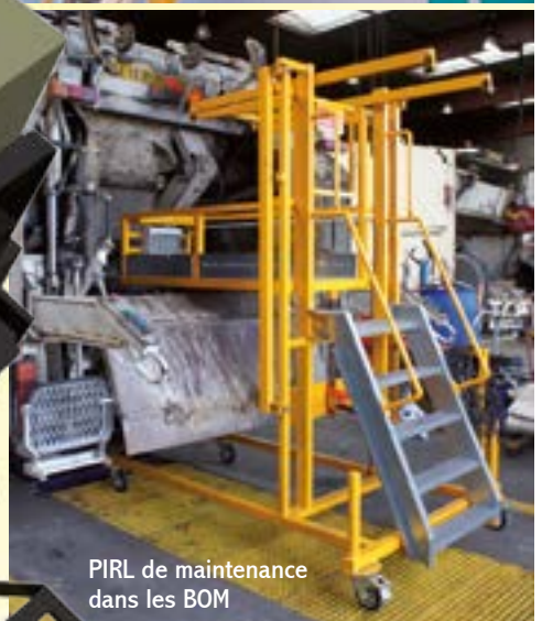
Echelle mobile d'accès sur dôme
