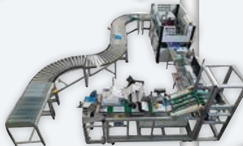
Ensemble pour dépiler, réaliser des paquets de produits et mise sous film
